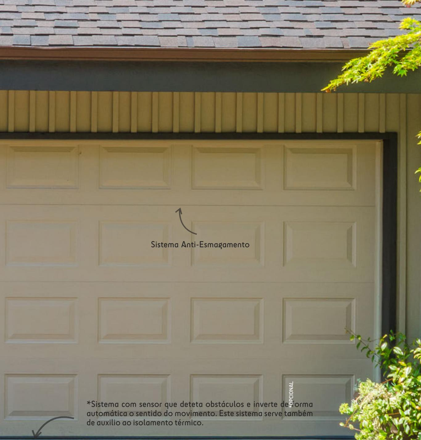
\*Sistema com sensor que deteta obstáculos e inverte de forma automática o sentido do movimento. Este sistema serve também de auxílio ao isolamento térmico.
